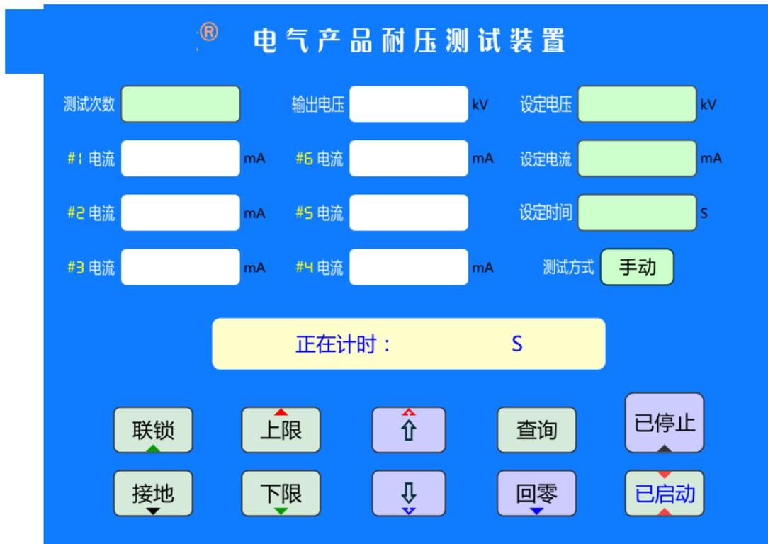
**测试次数**：显示当前第几次测试。 **输出电压**：实时显示当前输出电压。
