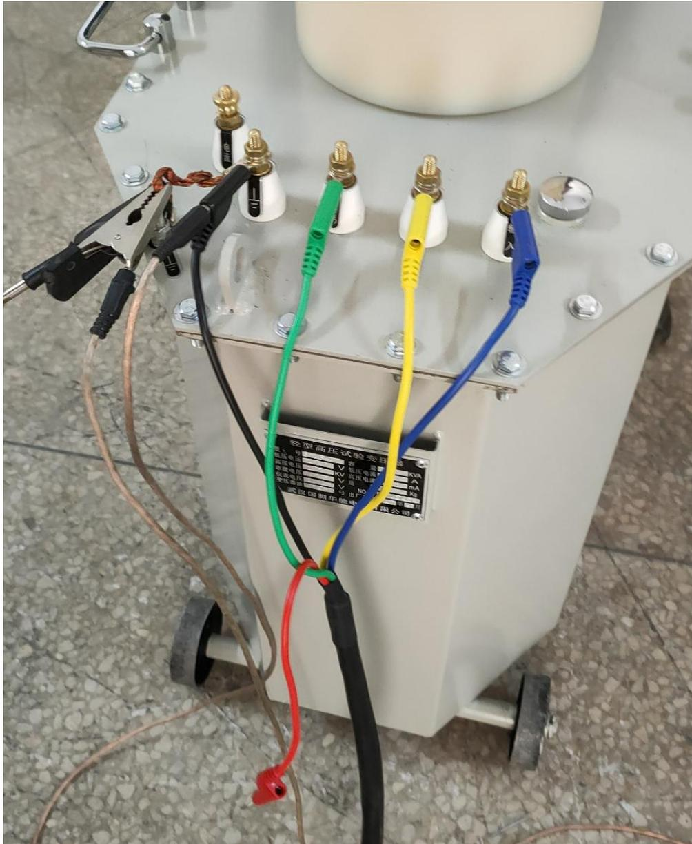
绝缘手套靴试验接线
