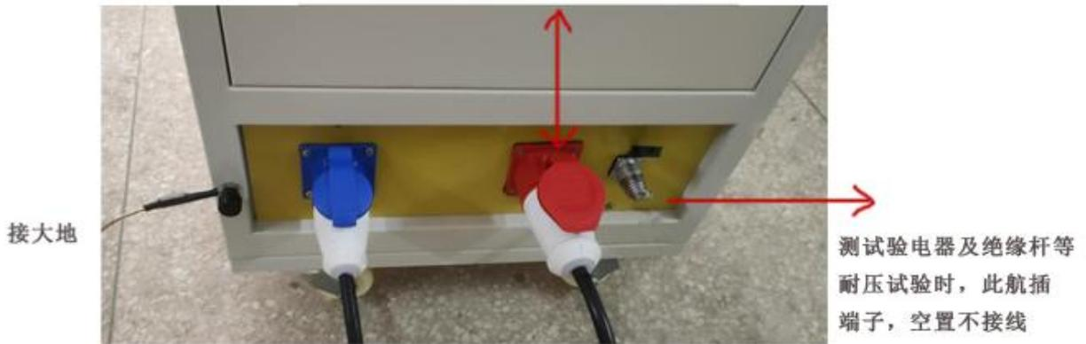
电源输入 (AC 220V)      至高压变压器
